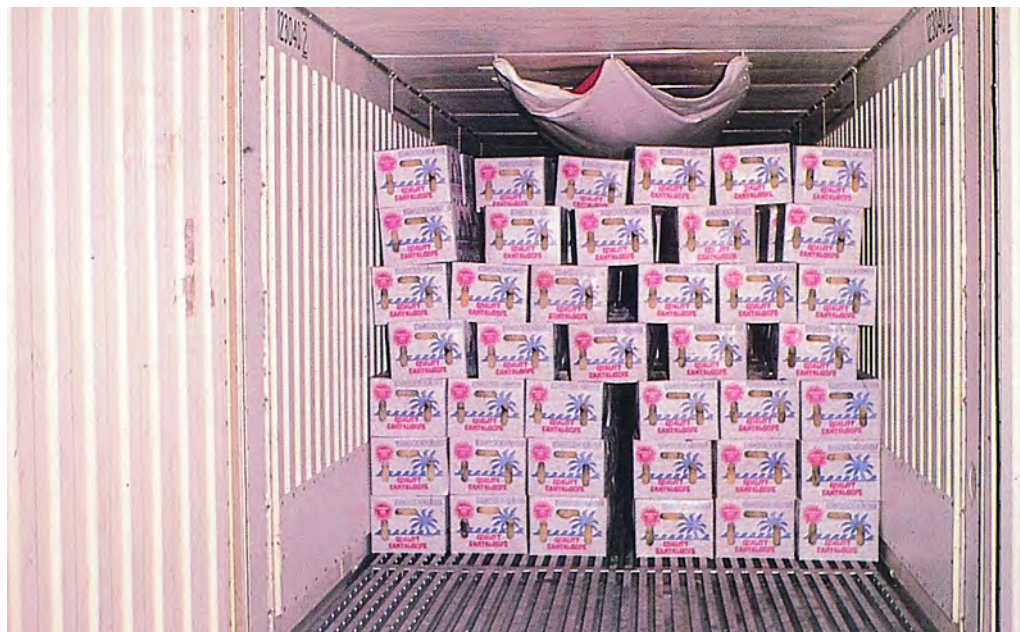
Un patrón de carga para flujo de aire horizontal fué empleado en este contenedor refrigerado cargado con cantalupos.
