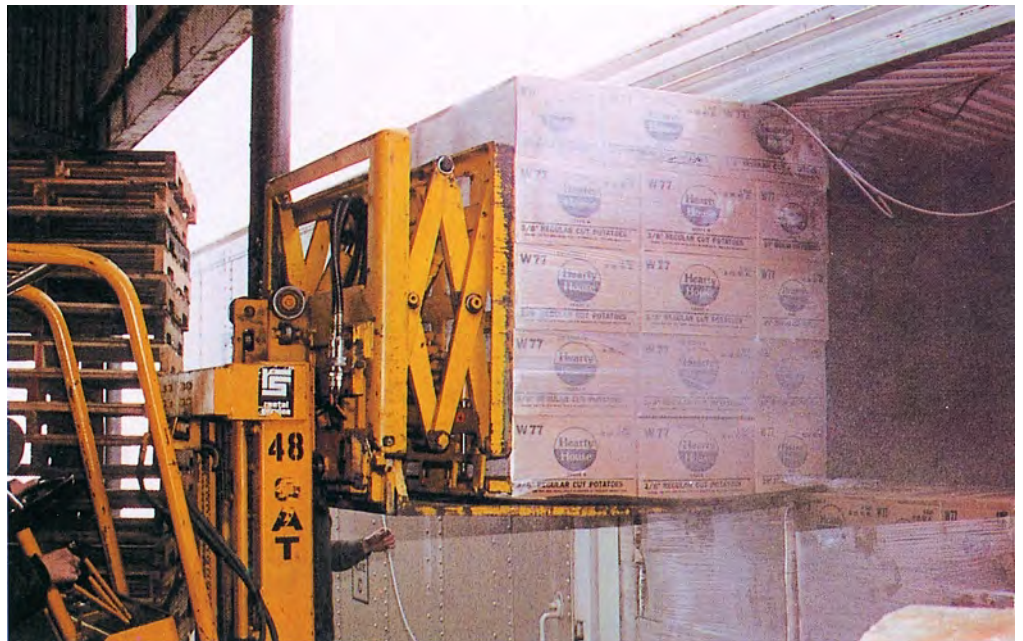
Una carga de papas congeladas unitizada sobre entrepaños con envoltura de película es descargada de un contenedor ferroviario por un montacarga con accesorio especial para empujar y halar.
