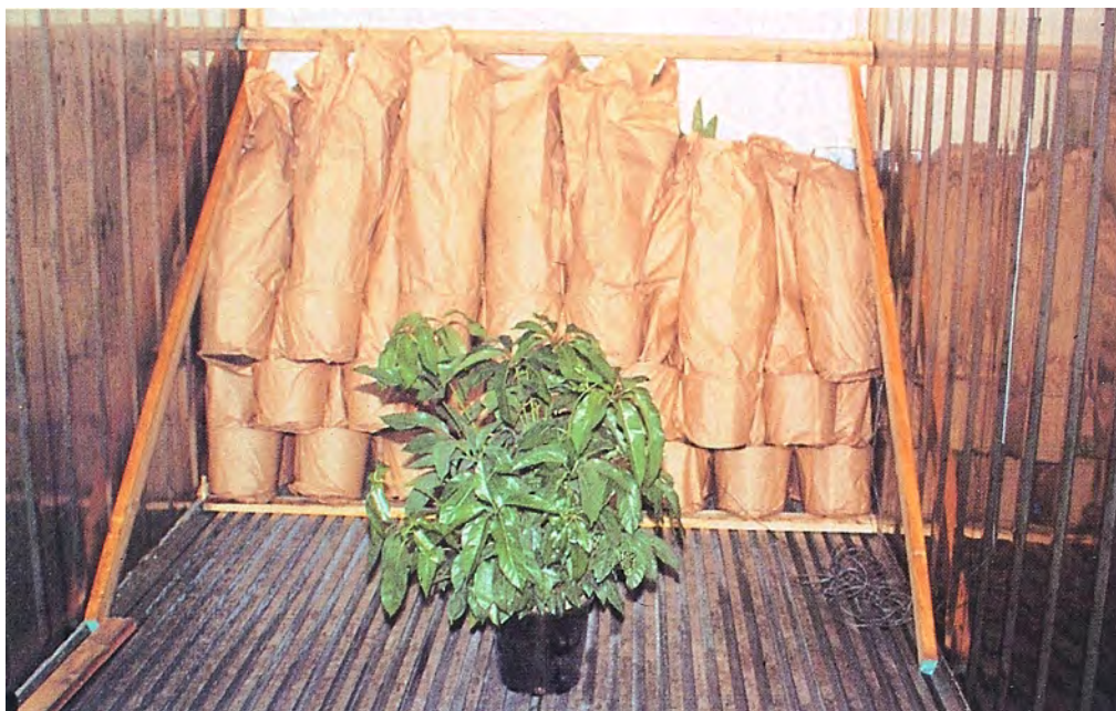
Macetas de plantas de follaje con mangas, apiladas contra el mamparo frontal de este contenedor refrigerado. Se emplean maderos para asegurar las plantas.
