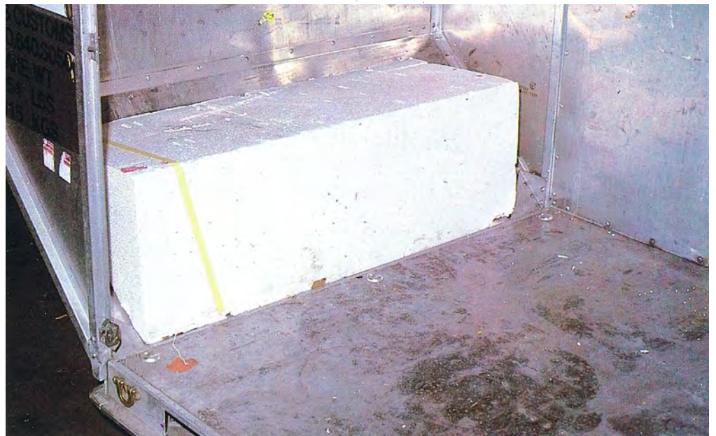
Espuma de poliestireno usada para calzar la carga y permitir la carga estable de cajas de fresas, papaya, piñas y otros productos sobre la superficie inclinada de un contenedor LD3.
